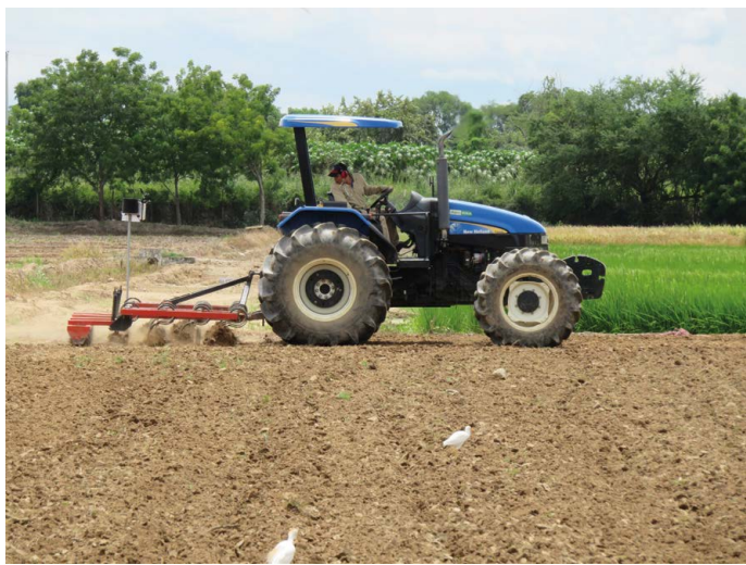
Figura 20. Preparación en seco del terreno para la siembra de arroz, empleando para ello la rastra de cinceles vibratoria. Fotografía: Diddier Moreira.
