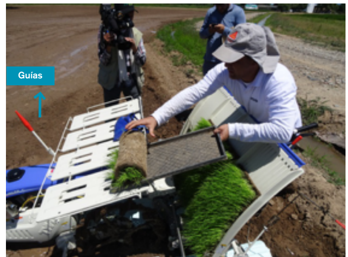
Figura 25b. Rollos de plántulas listas para el trasplante mecanizado y su colocación en el apero de la trasplantadora. Fotografía: Diddier Moreira.
