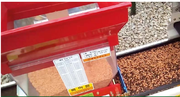
Figura 7b. Máquina llenadora de bandejas, donde se aprecia la uniformidad en la distribución de semillas. Fotografía: Diddier Moreira.
