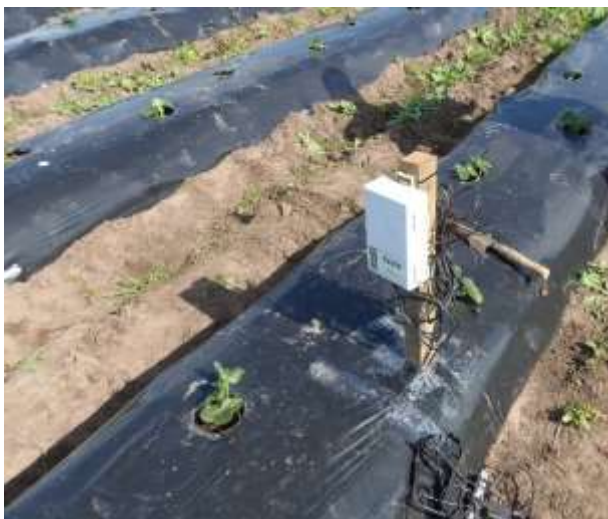
Figura 5. Sensores Decagon y datalogger Meter Group en cultivo de frutilla, San José, Uruguay.
