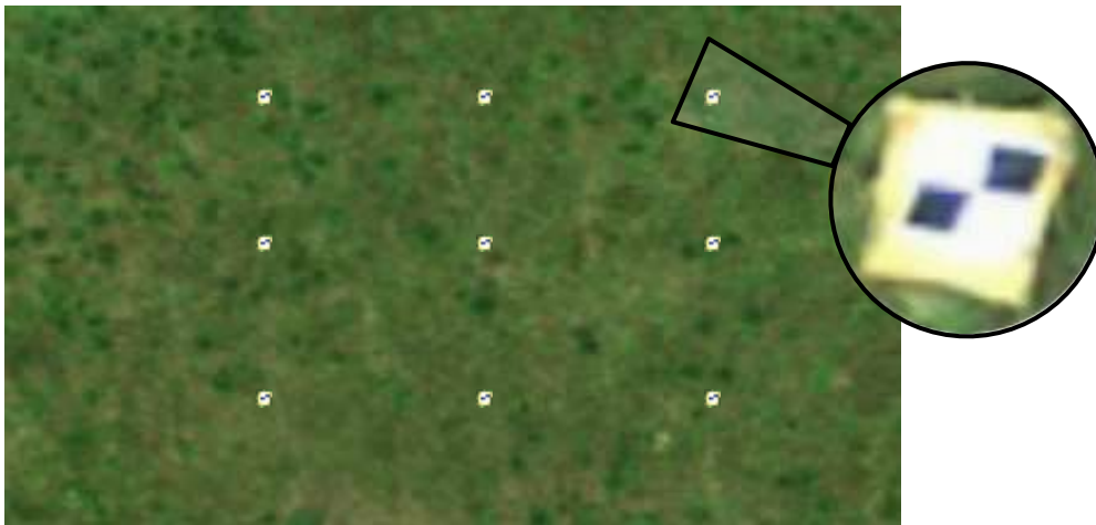
Figura 3: Ortomosaico elaborado a partir de imágenes del DRONE Matrice 200V2 tomadas con la cámara Sentera AGX720. Vuelo a 20m de altura y con 80% de superposición entre fotos. Se pueden visualizar las dianas que se colocaron sobre estacas fijas distanciadas a 10m entre sí. Detalle de las dianas: grilla de 2x2 de color blanco y negro intercalados. Cada celda tiene un tamaño de 5x5cm.
