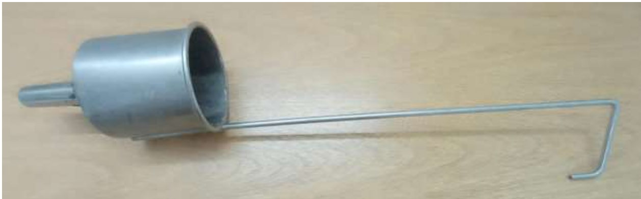
Figura 6: Barreno para tomar muestras de suelo 0-10cm.
