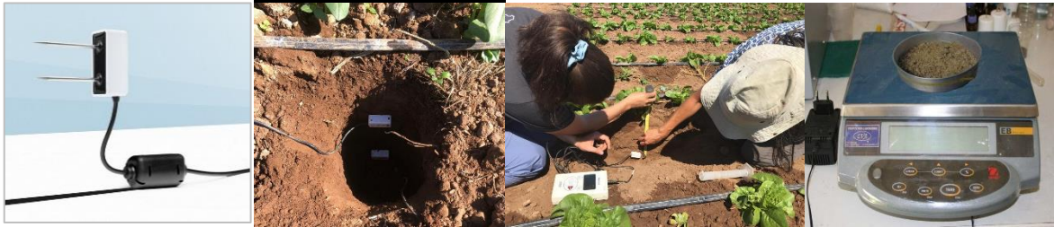
Figura 16. Sondas de capacitancia (mod. Teros 10, Decagon Devices) utilizadas para el monitoreo continuo de la humedad en el suelo.
