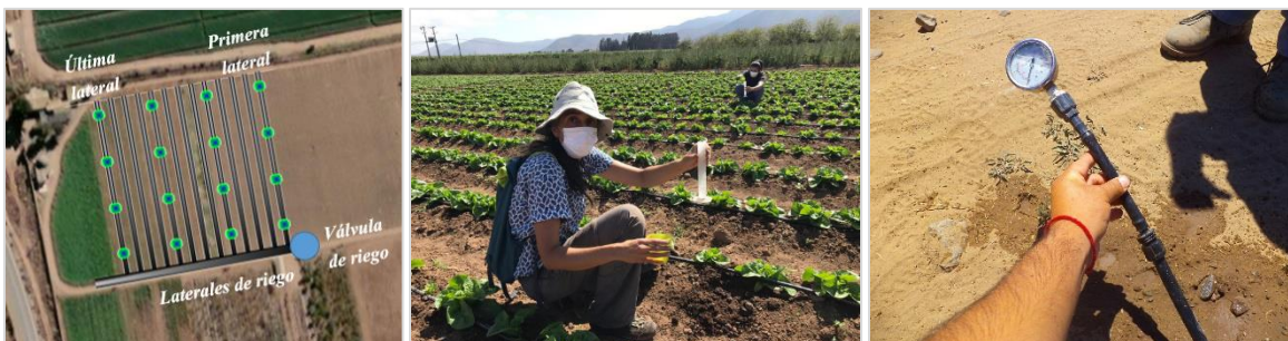
Figura 14. Selección de goteros y evaluación coeficiente de uniformidad y precipitación real del equipo de riego en parcela piloto.
