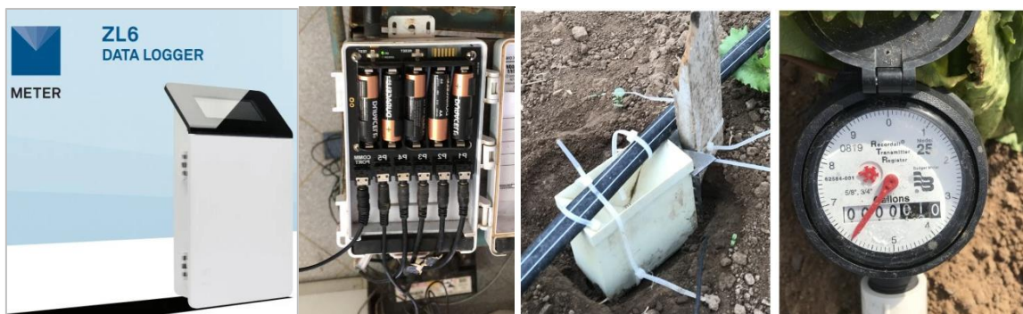
Figura 15. Datalogger Zentra, pluviómetro de gotero y caudalímetro utilizados para el monitoreo.
