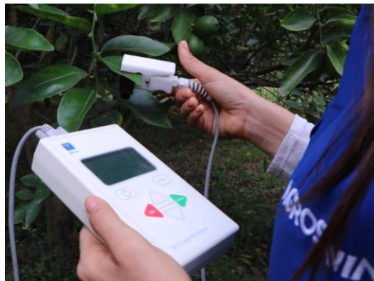
Figura 58. Evaluación de conductancia estomática con porometría.
