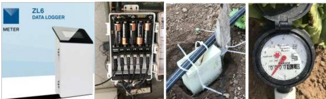
*Figura 10. Datalogger Zentra, pluviómetro de gotero y caudalímetro utilizados para el monitoreo.*
