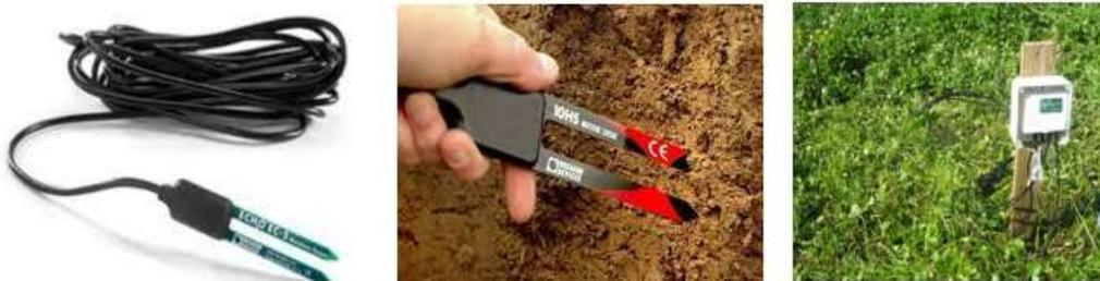
Figura 36. Sondas FDR (Decagon) utilizadas para el monitoreo continuo de la humedad en el suelo.
