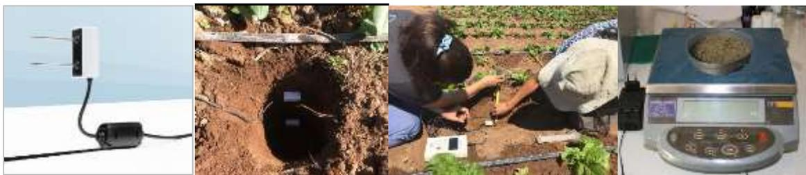
*Figura 11. Sondas de capacitancia (mod. Teros 10, Decagon Devices) utilizadas para el monitoreo continuo de la humedad en el suelo.*
