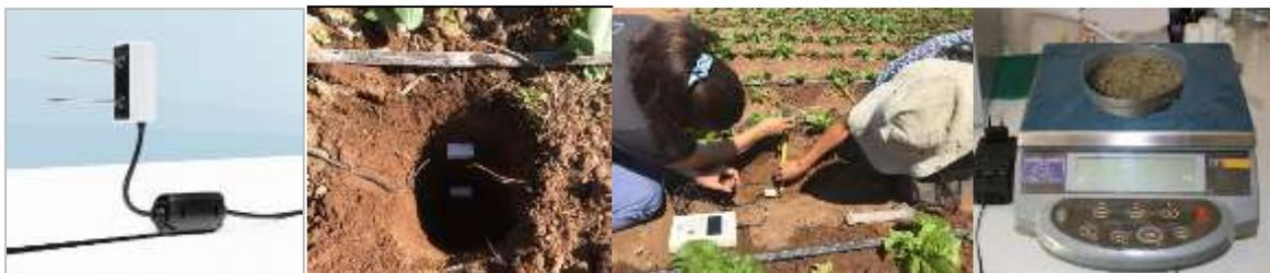
Figura 6. Sondas de capacitancia (mod. Teros 10, Decagon Devices) utilizadas para el monitoreo continuo de la humedad en el suelo.
