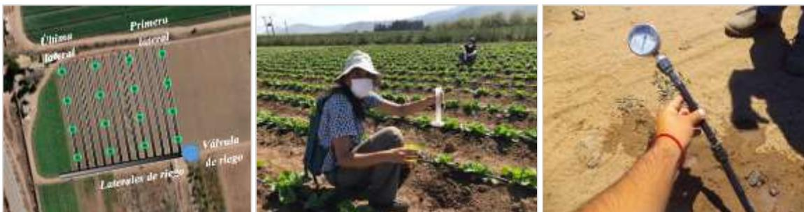
Figura 4. Selección de goteros y evaluación coeficiente de uniformidad y precipitación real del equipo de riego en parcela piloto.
