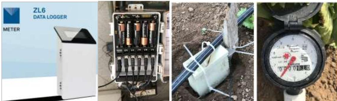
Figura 5. Datalogger Zentra, pluviómetro de gotero y caudalímetro utilizados para el monitoreo.
