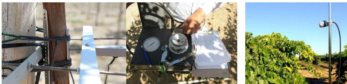
**Figura 17.** Monitoreo estado hídrico interno de los cultivos, dendrómetro de tronco, cámara de presión tipo Scholander y sensor de temperatura infrarroja.
