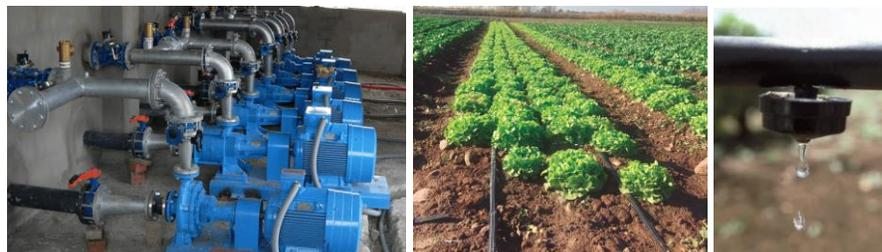
**Figura 11.** Riego tecnificado con equipos de bombeo, riego localizado y emisor.
