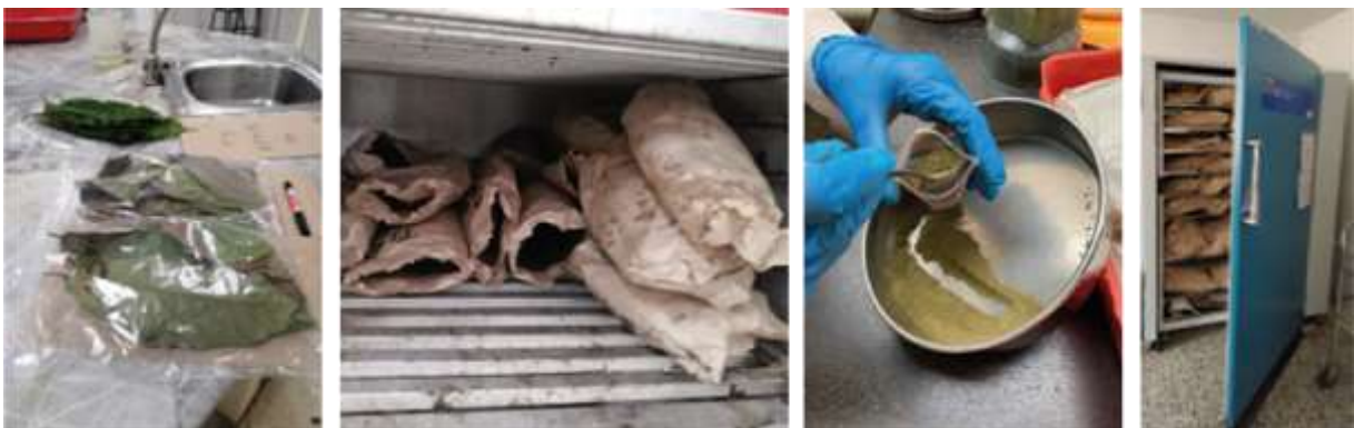
Figura 5. Preparación de muestras de hojas: secado, triturado y tamizado
