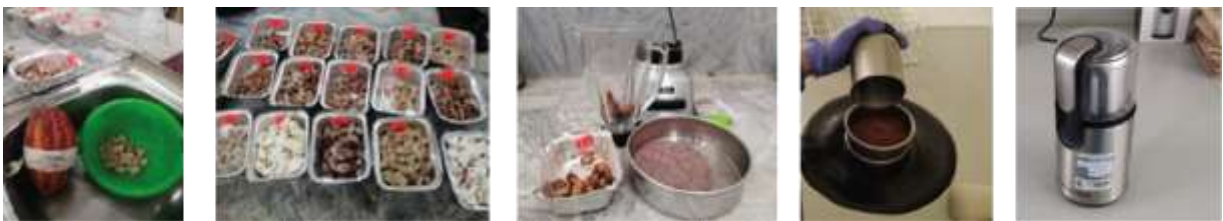
Figura 6. Preparación de muestras de almendras de cacao: lavado, secado y tamizado
