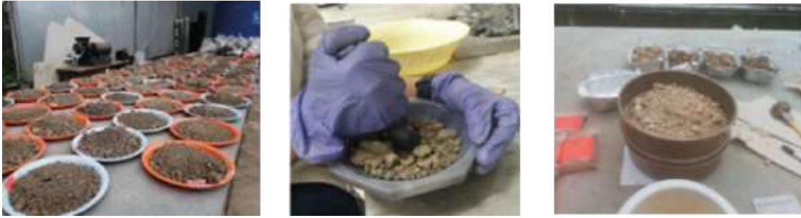
Figura 4. Preparación de muestras de suelo: secado, molido y tamizado.
