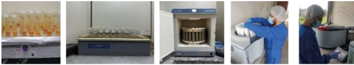
Figura 11. Equipos usados para mineralizar muestras de suelo y tejido. Plancha calentadora y hornos microondas
