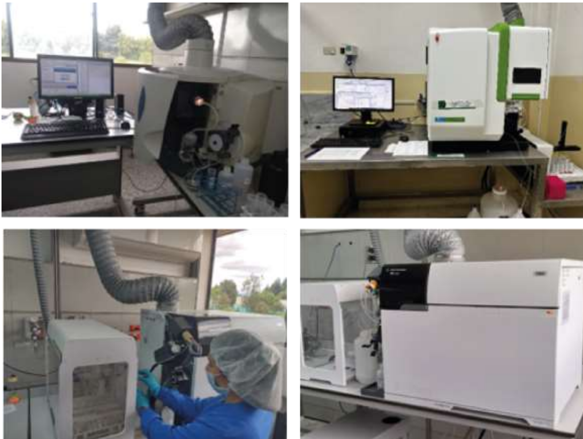
Figura 8. Equipos analíticos (ICP-OES, ICP-MS) utilizados para la determinación de Cd y otros elementos
