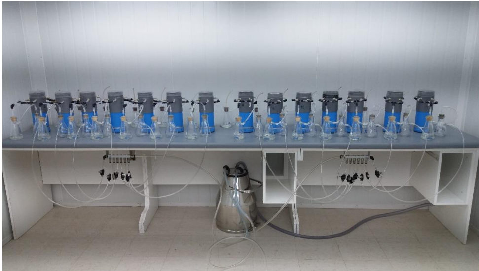
Fotografía 6: Cámaras estáticas para medición de N_2O .
