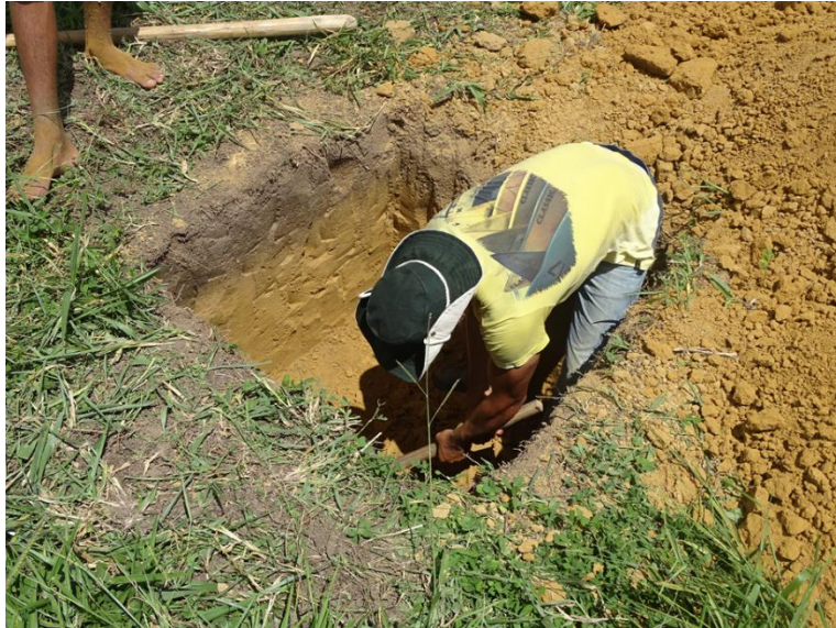
Fotografía 8: Calicata para la toma de muestras de suelo.
