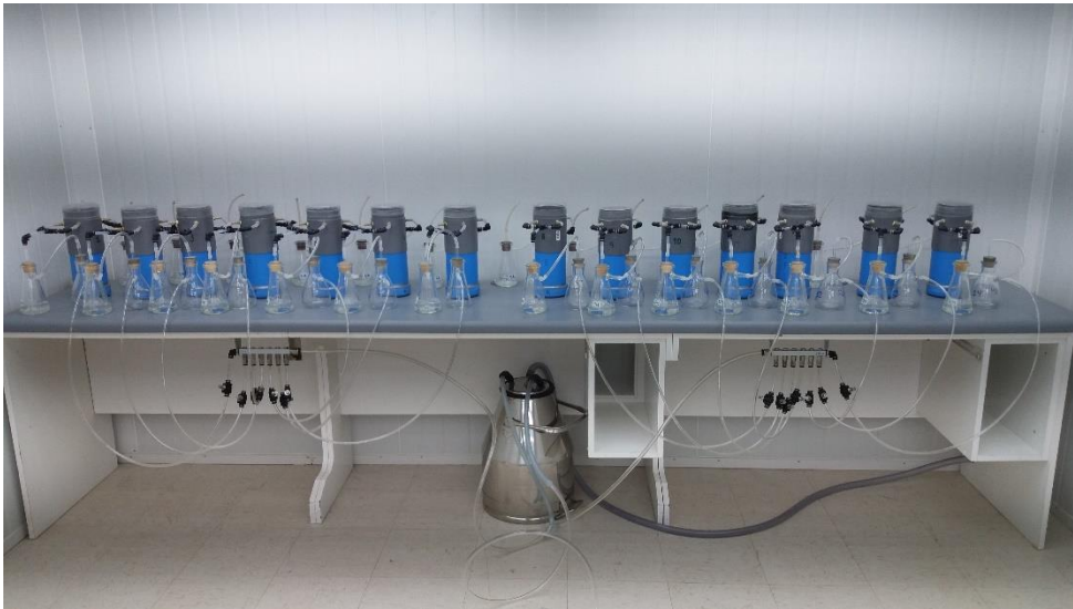
Fotografía 6: Cámaras estáticas para medición de N_2O .
