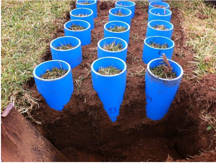
Fotografía 5: Minilímetros de PVC de 20 cm.
