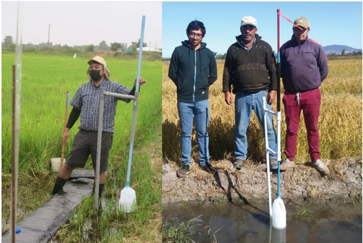
Figura 1. Sistema de medición de altura de la lámina de agua (Rice Checker).
