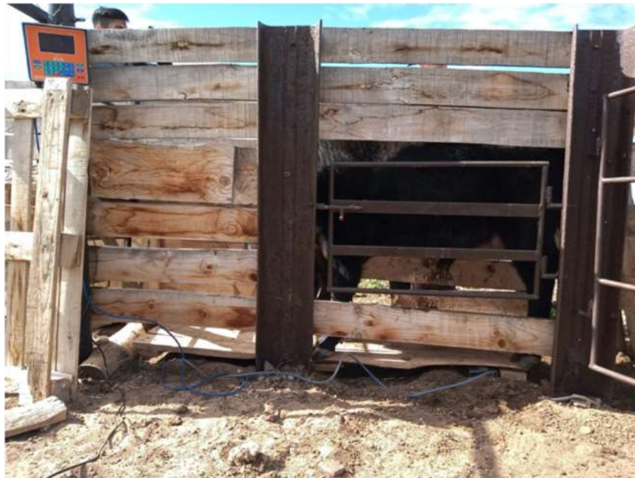
Figura n°3: Toma de los pesos de cada animal con la balanza digital adaptada a la manga
