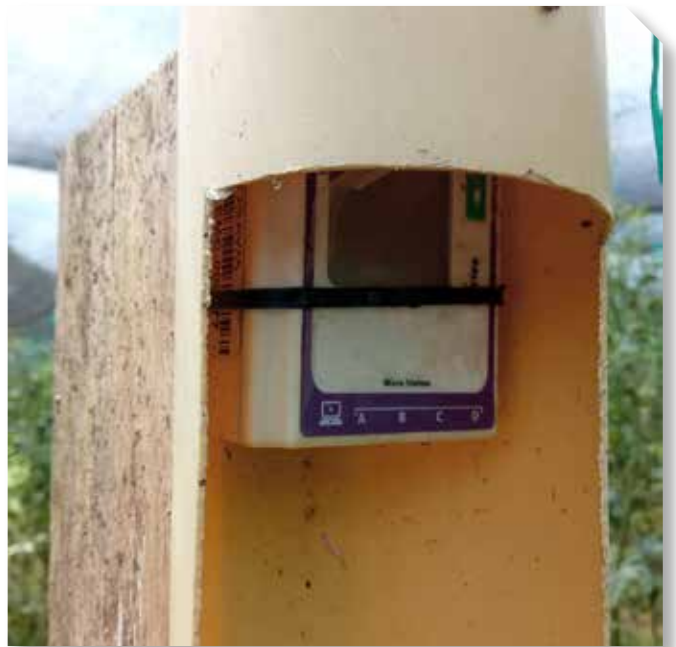
Figura 23. Sensores de temperatura y humedad relativa del aire.
