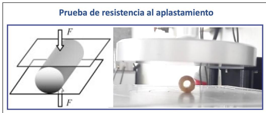
Figura 3. Esquema e imagen de prueba de resistencia al aplastamiento.
