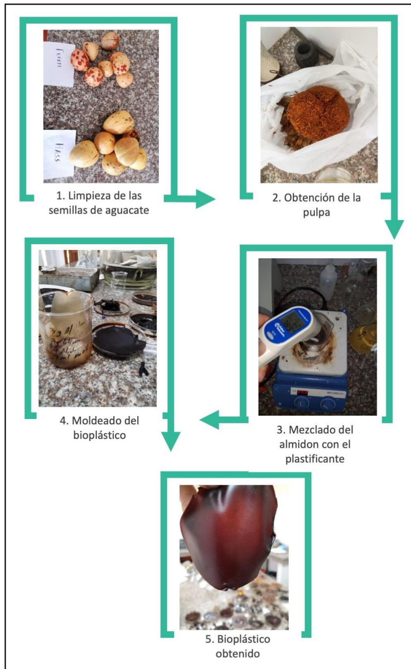
Figura 11 Etapas para la obtención de bioplástico a partir de la semilla del aguacate
