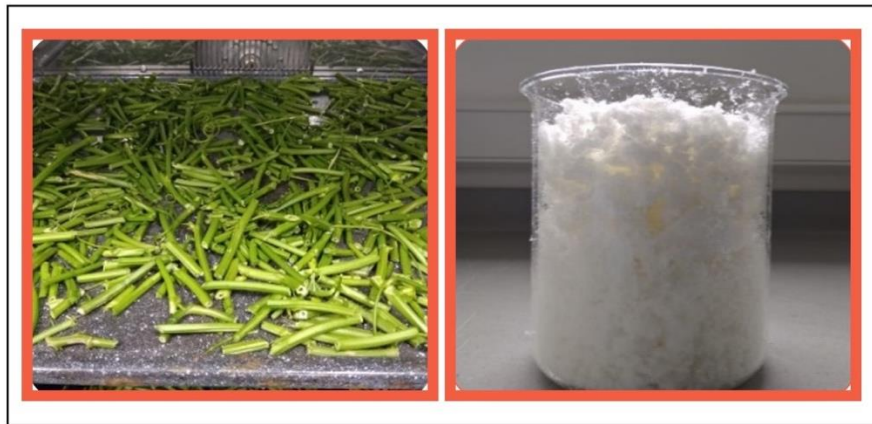
Figura 4 Tallos de maracuyá sin tratamiento (lado izquierdo) celulosa extraída después de los tratamientos químicos (lado derecho).
