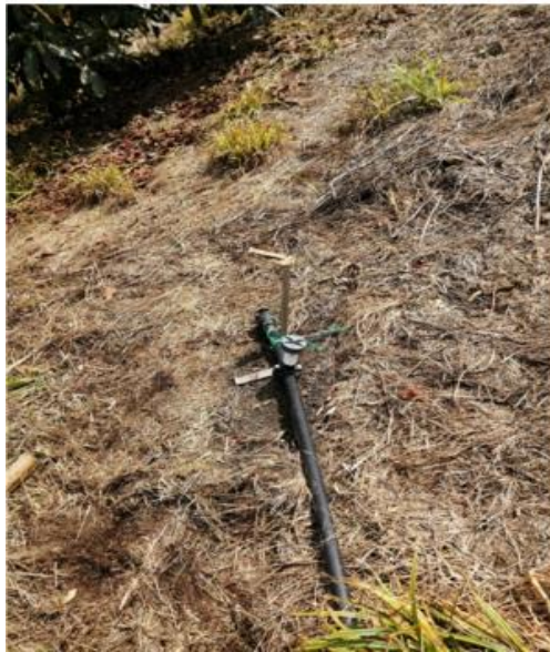
Gráficos 6 y 7. Sistema de desaireación al final de la línea
