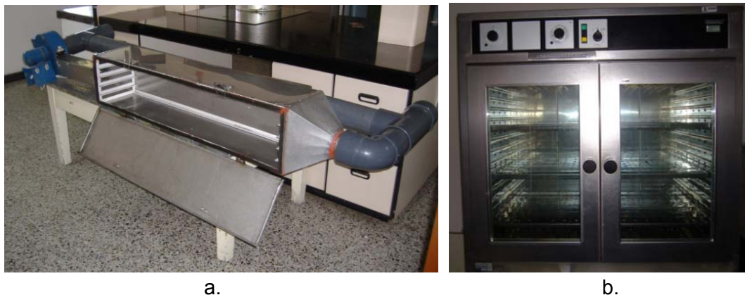
Figura 35. Equipo utilizado para el secado de uchuva: a. Deshidratador. b) Estufa MEMMERT
