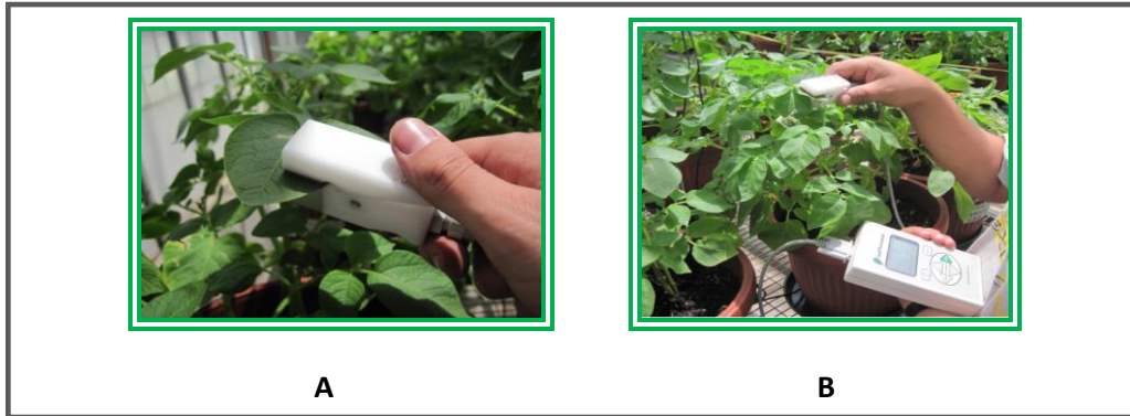
Figura 6. Medición de conductividad estomática, en papas regadas con un 100% y 25%. A: Pinzas, B: porómetro marca Decagón,USA.
