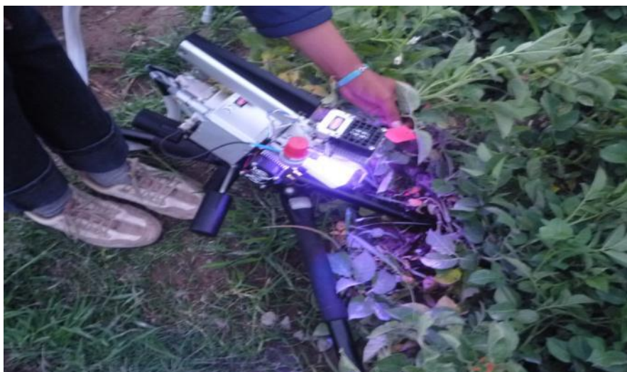
Foto 14. Colocación del foliolo dentro de la cámara del cabezal del equipo
