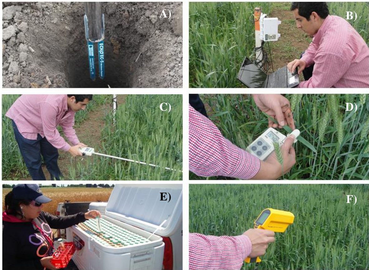
Foto 2. Instalación de sensores de capacitancias para monitoreo de la humedad del suelo (A), Registro y descarga de registro temporal del contenido de humedad de suelo (B), medición de la fracción de radiación fotosintéticamente activa interceptada con un ceptómetro (C), medición del contenido de clorofilas en hoja bandera (D), colecta de hoja bandera para la determinación de contenido relativo de agua y área foliar específica (F), medición de la temperatura de la planta mediante termometría infrarroja (F).
