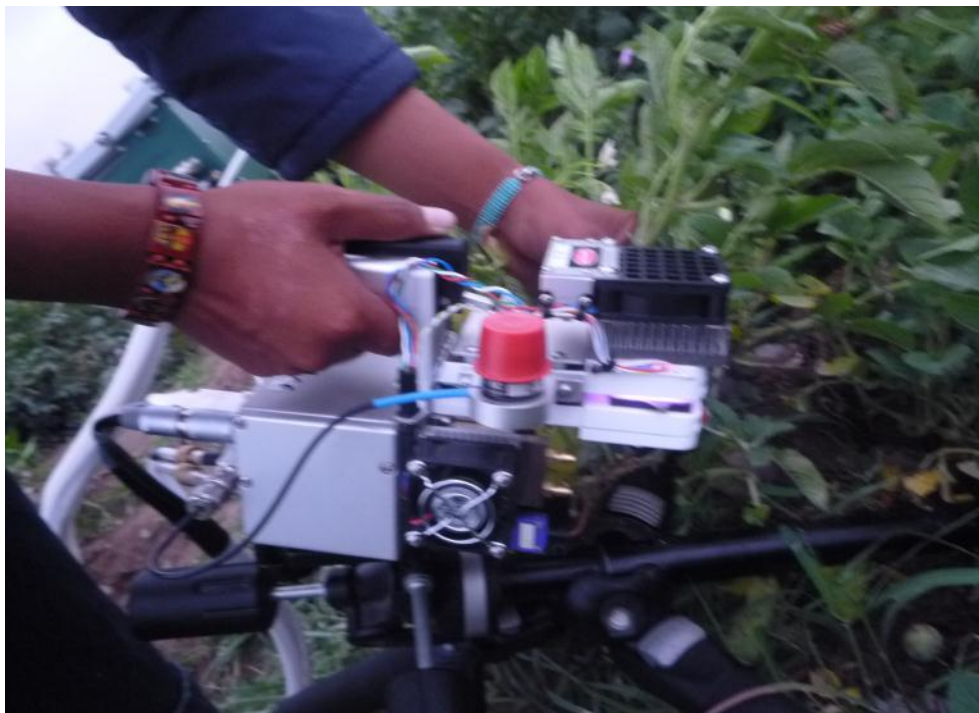
Foto 35. Cabezal del equipo de fotosíntesis con el sensor
