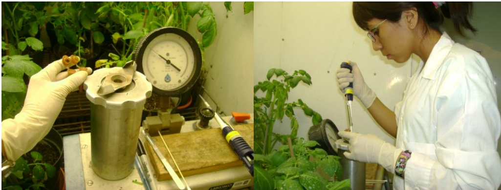
Figura 5. Extracción del jugo de xilema con la Bomba Scholander.
