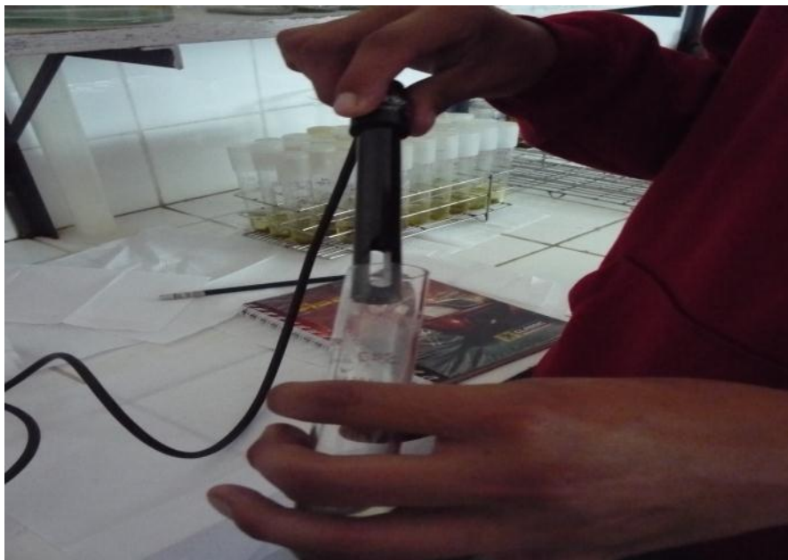
Foto 22. Lectura de la conductividad eléctrica de los discos de hoja de papa
