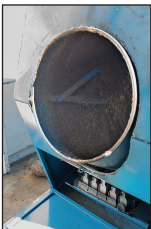
Figura 1: Secadora de bagazo construida con una mezcladora y un mechero de termotanque para acelerar el secado.
