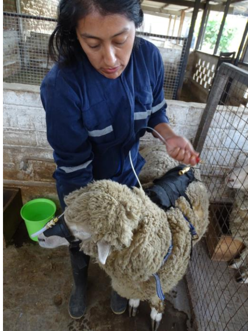
Foto 1. Colocación de elementos de colección de metano entérico en ovinos (UNA La Molina).
