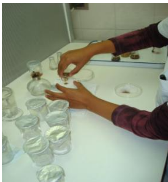
Figura 2. Filtración de las muestras de suelo mediante el uso de vendas de gasa como filtros.
