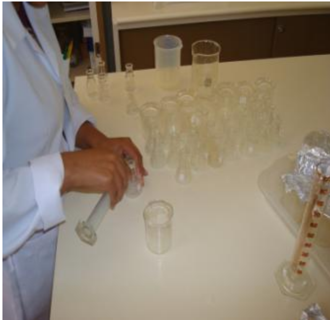
Figura 2. Dispensación de los medios de cultivo en los matraces de 25 ml de capacidad
