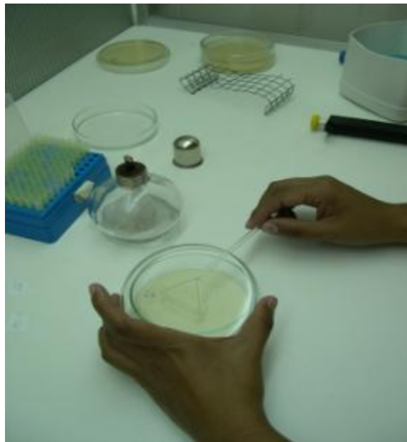
Figura 4. Siembra de las muestras en agar TSA con la ayuda del triángulo de Drigalsky.
