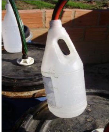
Figura 2. Trampa de escape de los gases.
