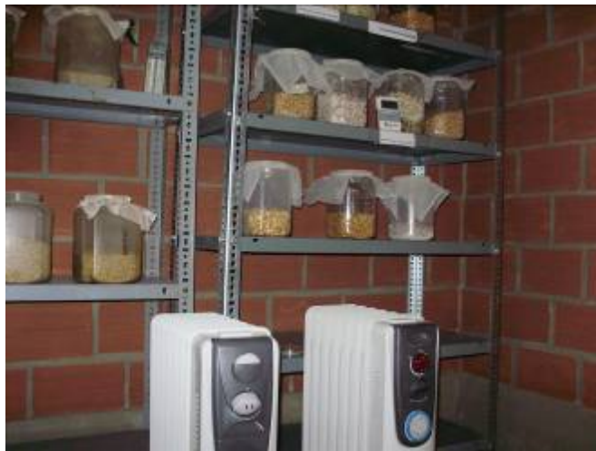
Figura 3. Estufas que mantienen la temperatura constante de 25 \pm 2^{\circ}\text{C}
